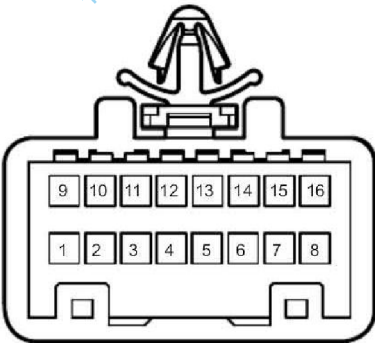
DR14 前乘员侧门玻璃升降器开关线束连接器
